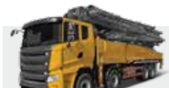
Pompe à béton
